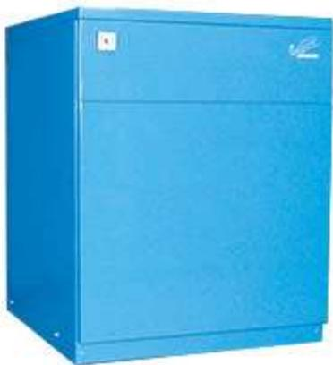
Котел отопительный водогрейный стальной модели «Хопер» (далее котел) предназначен для водяного отопления жилых и служебных помещений с принудительной циркуляцией воды в автоматическом режиме по контролю тяги, температуры котловой воды, отсутствию пламени на запальной горелке. Допускается работа котла с естественной циркуляцией воды в системе отопления (без циркуляционного насоса) при условии обеспечения паспортного расхода воды через котёл.
